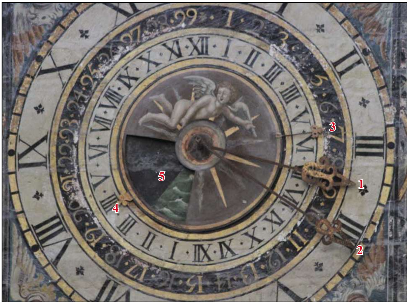
Vue rapprochée du cadran principal. 1-Aiguille des heures. 2-Aiguille des minutes. 3-Aiguille du jour lunaire. 4-Aiguille de l'heure de la prochaine marée haute. 5-Encart des vives et mortes-eaux
