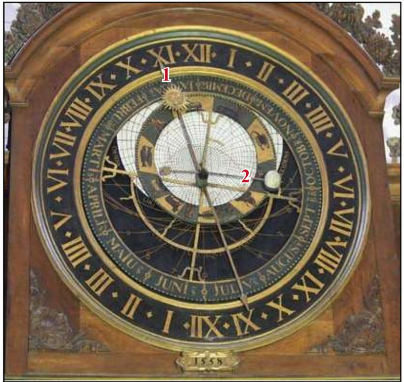
Vue générale de l'horloge. L'aiguille portant le Soleil (1) indique l'heure et la date. L'aiguille portant la Lune (2) indique la phase de Lune et dans quelle constellation elle se trouve.
